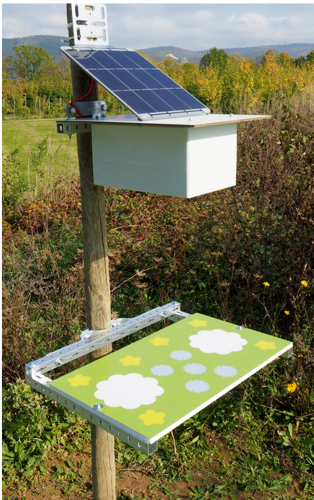
KI-basierte Insect Detect Kamerafalle zur kontinuierlichen und automatisierten Erfassung blütenbesuchender Insekten auf den Untersuchungsflächen. Eingesetzt im Rahmen des Projekts zum Monitoring der Vielfalt in Agrarlandschaften (MonViA).
